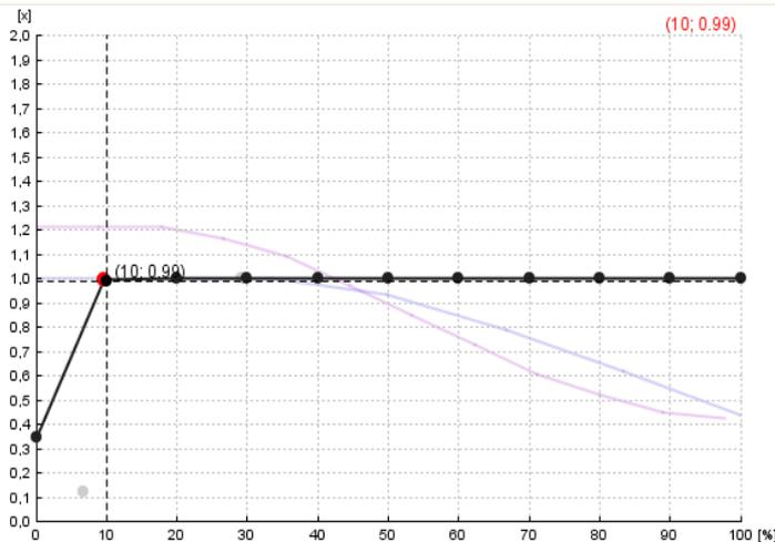
La corrección del multiplicador (p.ej. 1.0 es 100%, 0.6 es 60% la compensación del desplazamiento original) del ángulo en relación con el valor de la señal TPS.
