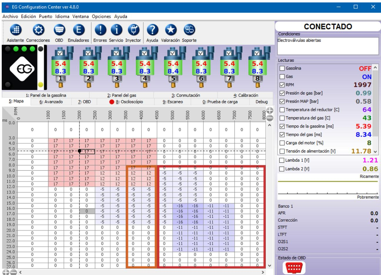
En esta pestaña es posible realizar el ajuste de la composición del aire/mezcla de combustible en rangos específicos del tiempo de apertura de la inyección de gasolina <0...27 ms> dependiendo del nivel de RPM <0...8000 RPM>. Estos rangos pueden ser ajustados haciendo clic y arrastrando la sección de línea a la altura de los rótulos *ms* o *RPM*.
