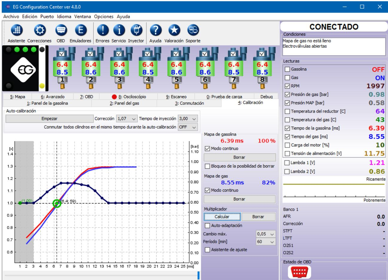
El mapa de la pestaña "**Calibración**" muestra la dependencia del tiempo de apertura de los inyectores de gasolina [ms] en gasolina (puntos rojos) y el tiempo de apertura de los inyectores de gasolina en gas (puntos azules) en relación con el valor de la presión absoluta del colector [kPa]. En la parte derecha de la pestaña de Calibración están las indicaciones del mapa de gasolina (color rojo) y mapa de gas (color azul) y los búfers [%].
