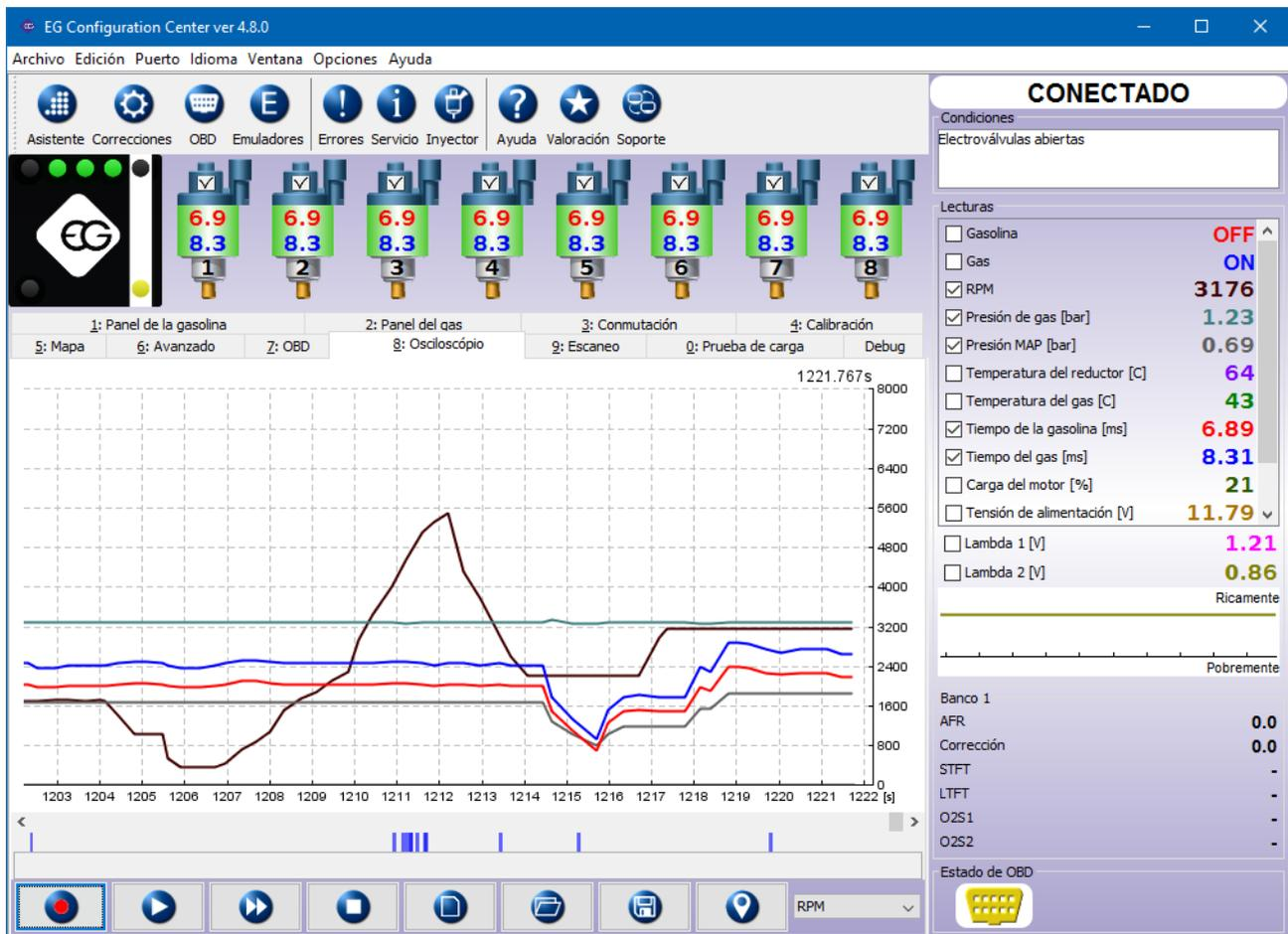
El osciloscopio muestra como van las señales de la ECU seleccionada. En el lado derecho de la ventana principal podemos seleccionar (marcando en las casillas) que señales ECU querríamos ver funcionar en el osciloscopio. También podemos visualizar las lecturas OBD requeridas seleccionando desde el icono OBD localizado en el lado izquierdo de la barra de herramientas.
