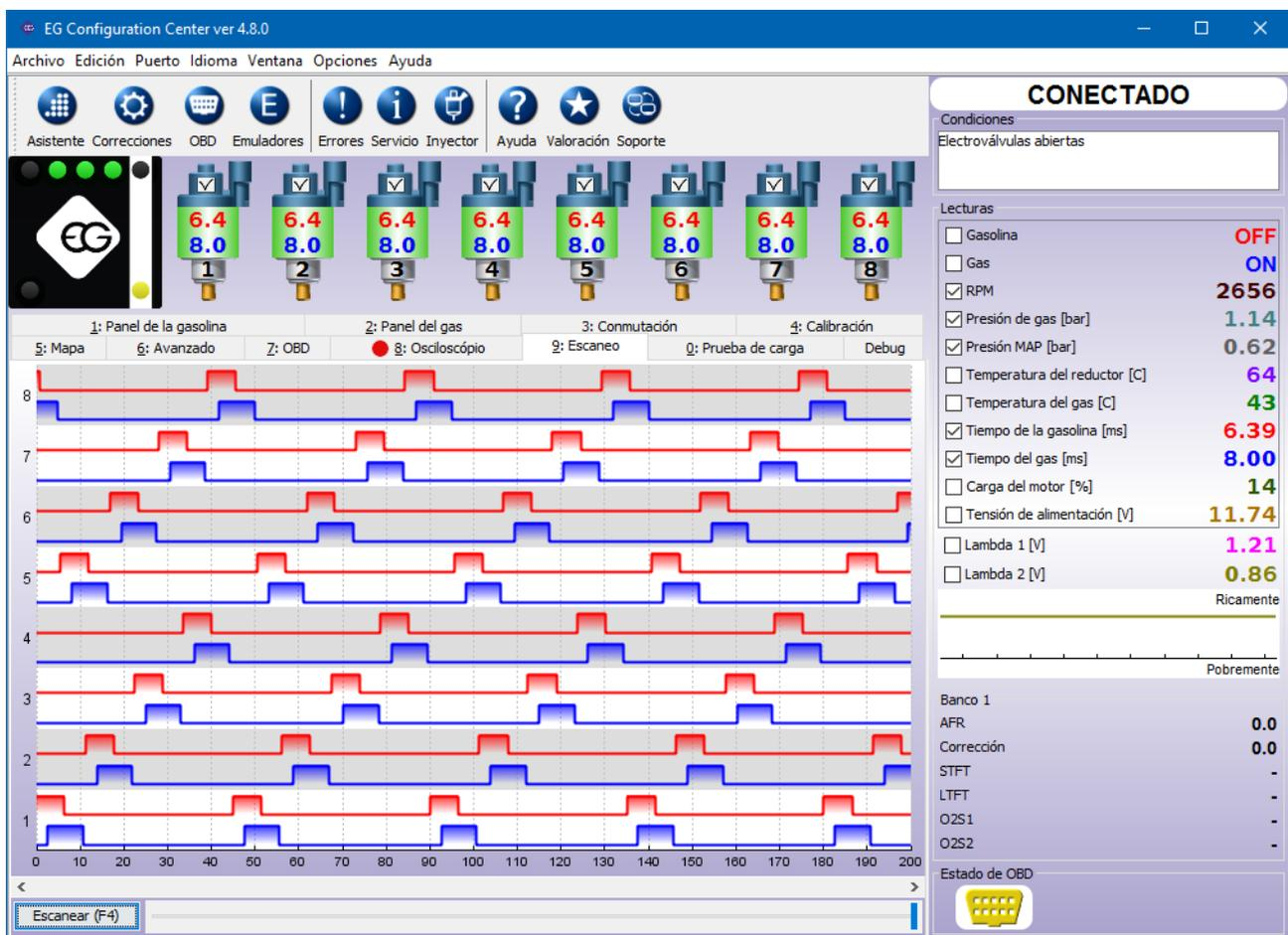
El escaner de la inyección de gasolina y gas del osciloscopio es una herramienta útil para propósitos de diagnóstico. Con el uso de este escaner es posible comprobar: el orden de la secuencia de la inyección, la ocurrencia de solapamiento de los inyectores, la presencia de pre-impulsos cortos de inyección, etc.
