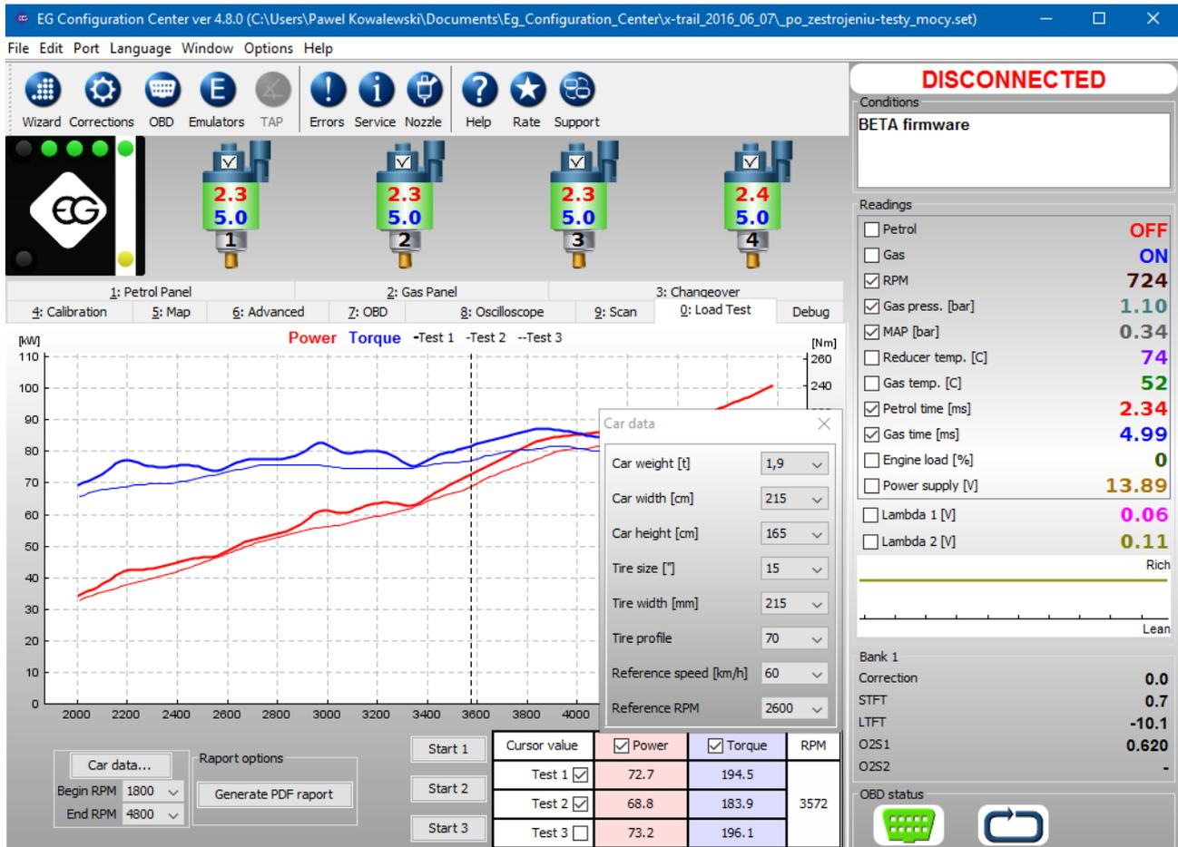
El módulo de la prueba de carga implementada permite medir la potencia y torsión del motor del vehículo durante la prueba de conducción.
