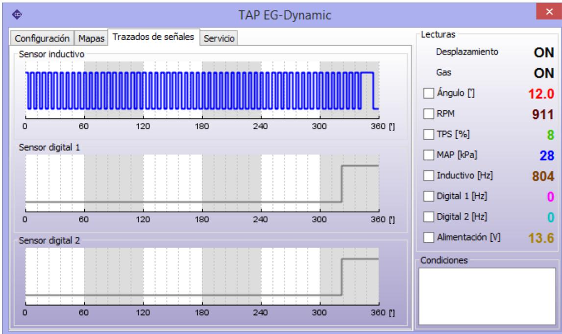
En este marcador podemos previsualizar la forma de cada onda de señal del sensor escaneado.
