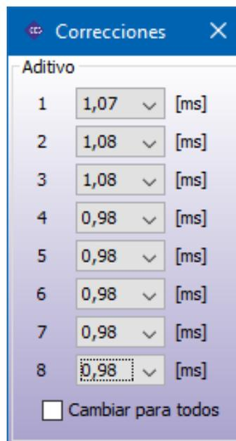
Muestra la ventana de las correcciones aditivas. El valor de esta corrección [ms] está siendo añadida para la apertura de la inyección de gasolina cuando el coche funciona en gas. Este valor es ajustado por el programa automáticamente durante el proceso de auto-calibración.
