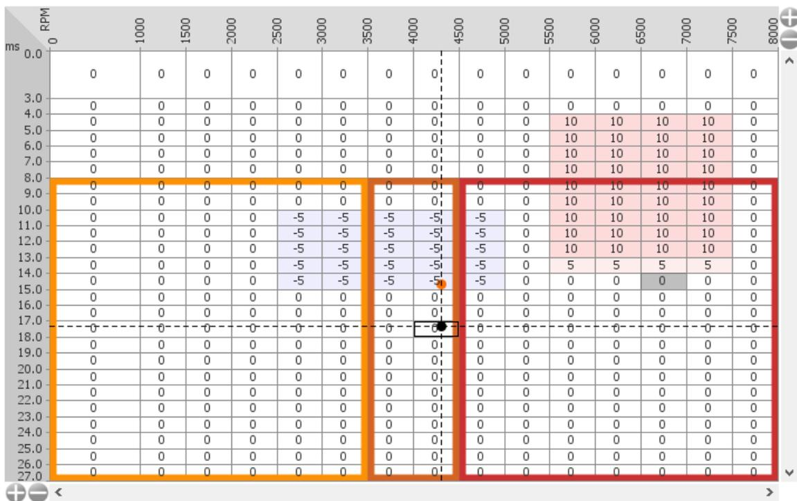
Para ajustar adecuadamente la composición de la mezcla, con la función de extra inyección de gasolina activada, se utiliza un marcador EPT (el tiempo equivalente de gasolina). El Marcador EPT tiene el color naranja. La posición del cursor en el mapa muestra qué tiempos de inyección necesitan ser cambiados para modificar la composición de la mezcla cuando hay extra inyección de gasolina.
