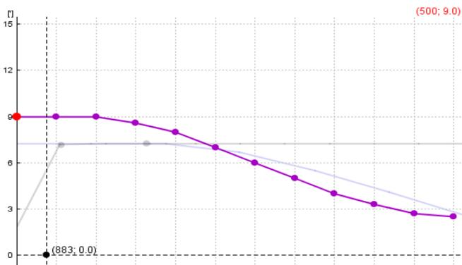
El mapa del ángulo de desplazamiento con respecto a la velocidad de rotación del motor.
