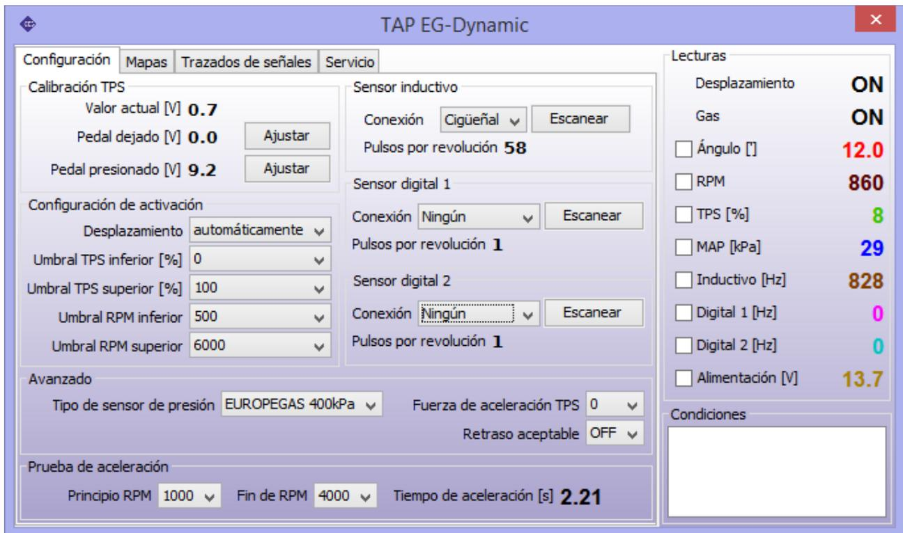
Muestra la interfaz y los marcadores relacionados con la configuración de la función incorporada EG Dynamic del módulo Timing Advance Processor.
