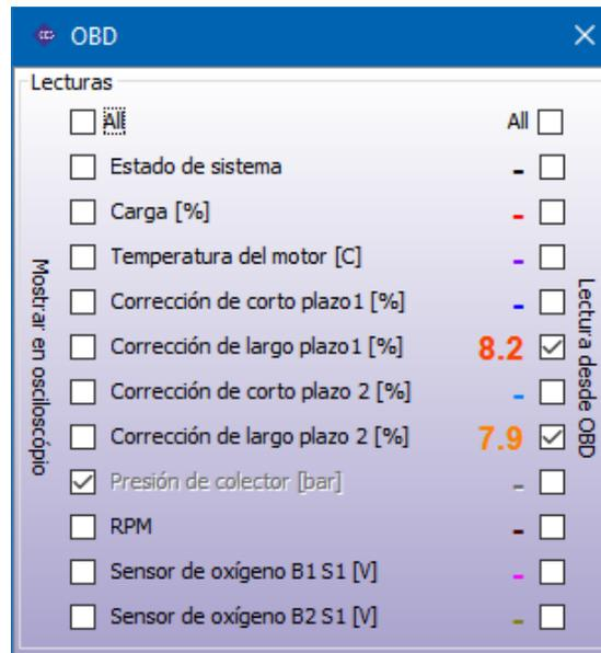
Muestra el contenido de la ventana de todas las lecturas OBD disponibles y permite la selección de los parámetros para ser leídos desde OBD y ser visualizados en el funcionamiento del osciloscopio.
