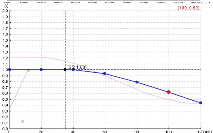
La corrección del multiplicador (p.ej. 1.0 es 100%, 0.6 es 60% la compensación del desplazamiento original) del ángulo en relación con el motor de colector de presión absoluta (carga del motor). Para cargas pesadas se recomienda fijar el ajuste por debajo de 1,0 y no aumentar el valor de golpeteo del motor.
