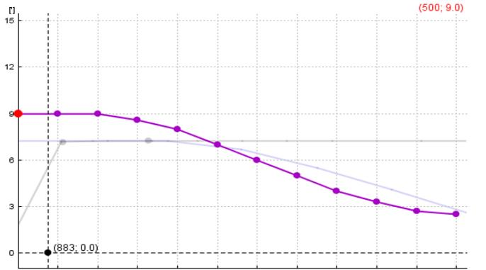
El mapa del ángulo de desplazamiento con respecto a la velocidad de rotación del motor.
